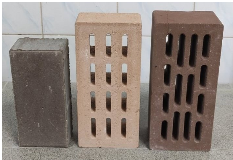
Рис. 3. Опытные образцы тротуарной плитки и кирпича Fig. 3. Prototypes of paving slabs and bricks
