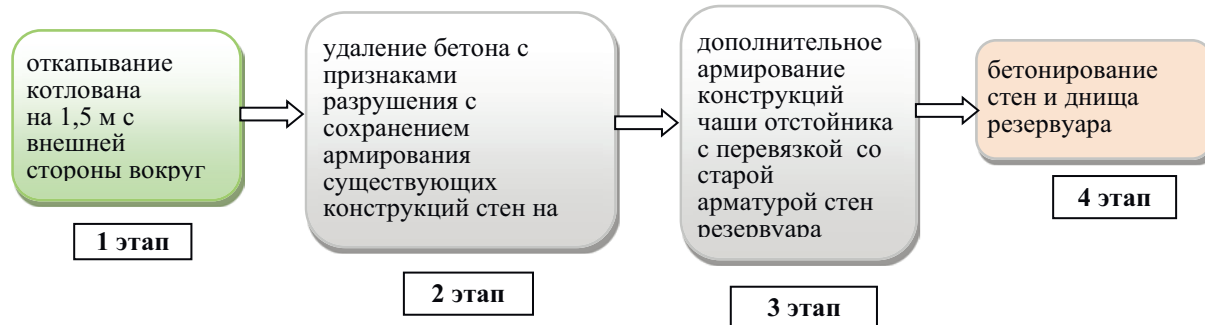
Рис. 2 Этапы выполнения работ по бетонированию внутренней чаши отстойника Fig. 2 Stages of concreting the inner bowl of the sump tank
