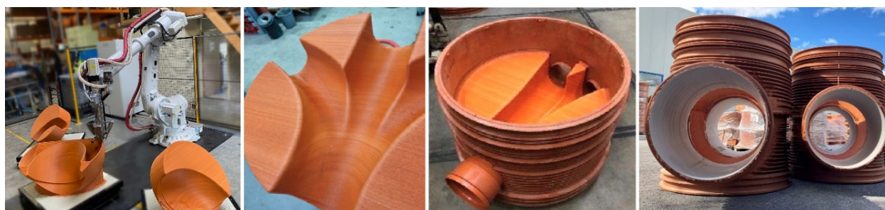
Рис. 3. Примеры 3D-печати ME (FDM) пластиком для сферы транспортировки сточных и ливневых вод компании Pipelife [36].
