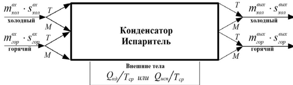
Рис. 2. Потоки энтропии в конденсаторе Fig. 2. Entropy flows in a condenser
