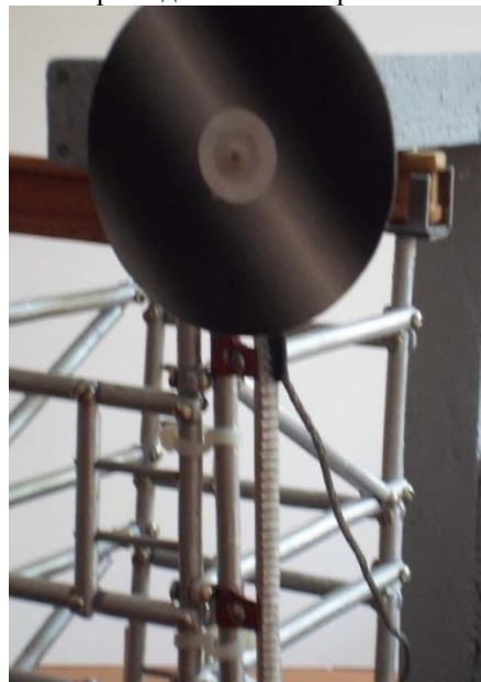
Рис. 5. Макет дисковой алмазной пилы на поддерживающих конструкциях инвентарных лесов
