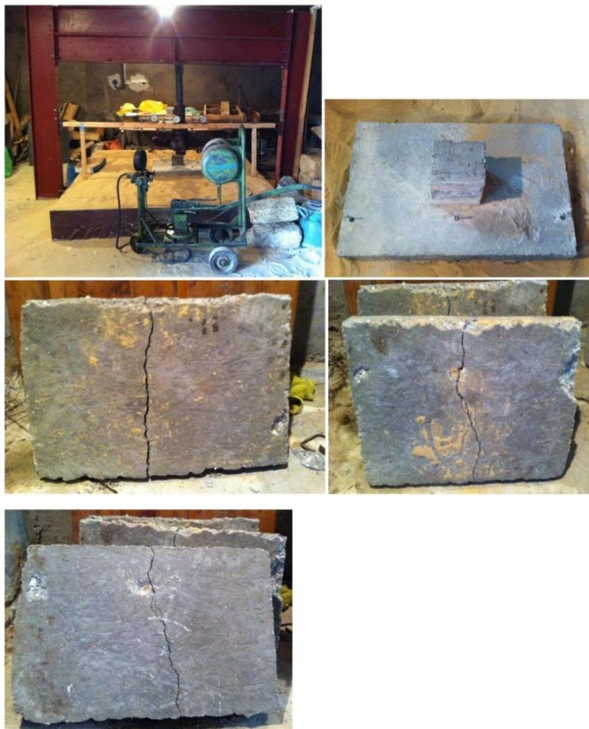
**Рис. 1.** Грунтовый лоток с моделью фундамента, трещины на подошве моделей после разрушения
