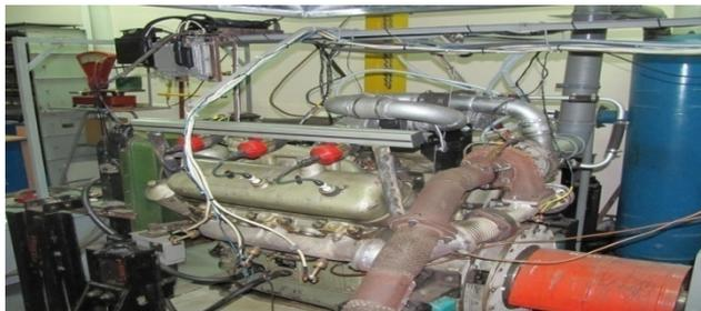
Рис. 6. Общий вид экспериментального стенда с микро-ТЭЦ на базе ДВС ЯМЗ-236
