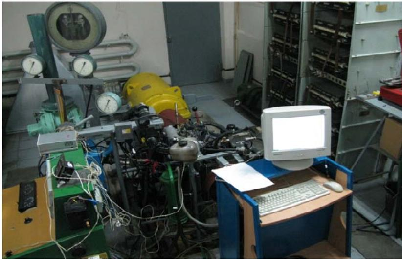
Рис. 2. Общий вид экспериментального стенда с микро-ТЭЦ на базе ДВС MeM3-307
