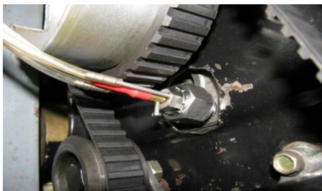
Рис. 4. Посадочное место для установки датчика давления в цилиндре двигателя ЯМЗ-236
