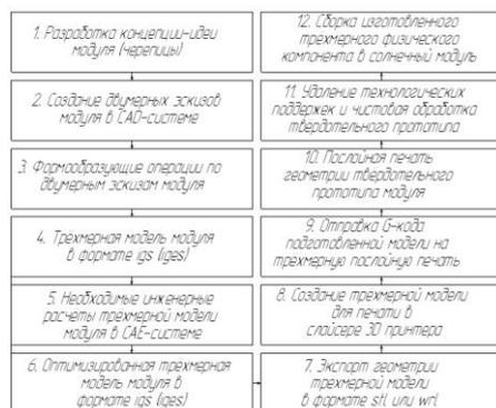
**Рис. 11.** Методика изготовления трёхмерных твёрдотельных прототипов компонентов солнечных модулей с использованием послойной печати, реализуемая в программных комплексах 3D принтера и КОМПАС 3D
