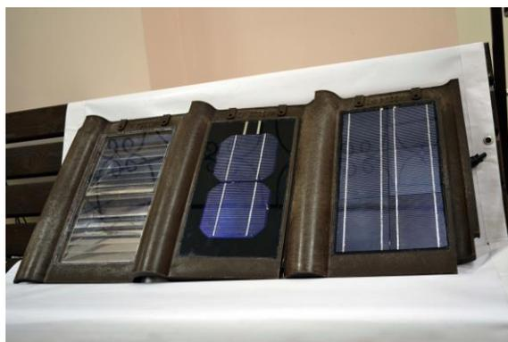
**Рис. 2.** Кровельные солнечные панели в концентраторном и планарном исполнениях, изготовленные по трём разработанным технологиям
