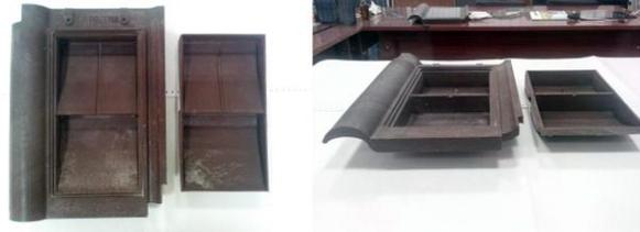
**Рис. 12.** Изготовленные подложки черепицы стандартным дорогостоящим способом (для экспериментальных единичных образцов) штамповки по матрице
