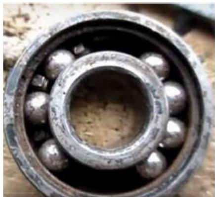
**Рис. 15.** Поломка подшипника качения с разрушением обоймы и тел качения
