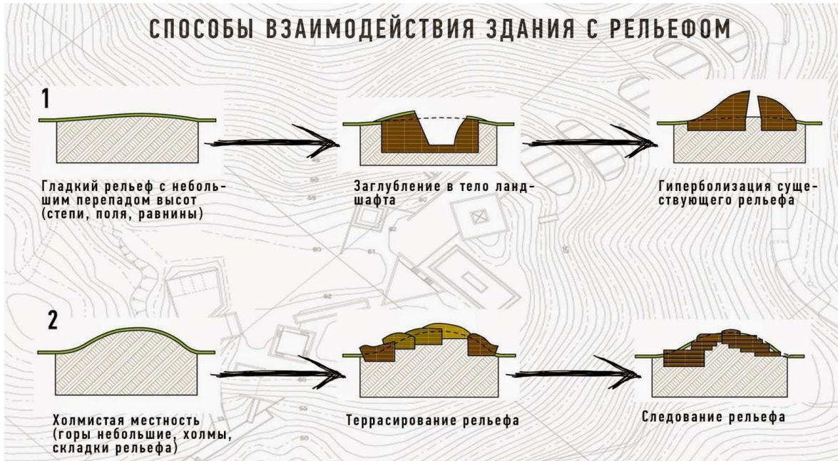
Рис. 3. Способы взаимодействия здания с рельефом. (Автор не известен)
