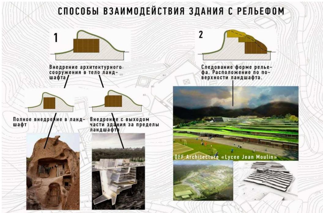
Рис. 1. Способы взаимодействия здания с рельефом. (Автор не известен)
