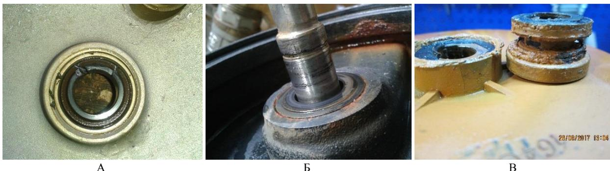
**Рис. 12.** Поломки торцевого уплотнения насоса:
