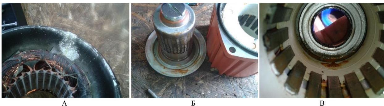
**Рис. 11** - Вид сгоревшего электродвигателя насоса: А – сгоревшие обмотки статора; Б – ротор со следами попадания воды, В – статор, на поверхность которого попала вода
