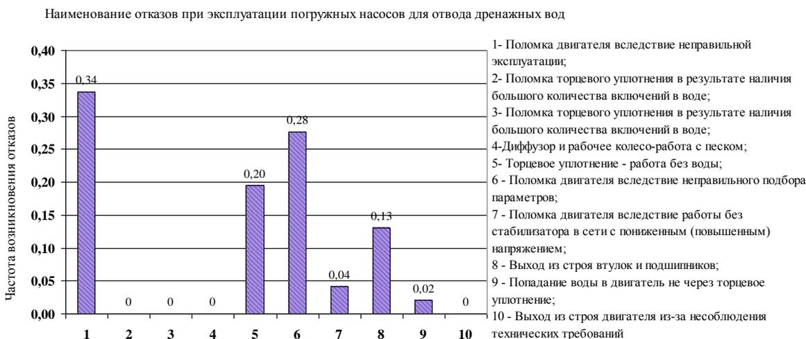
**Рис. 2.** Гистограмма распределения по группам отказов среди реализованных погружных насосов, предназначенных для отвода дренажных вод
